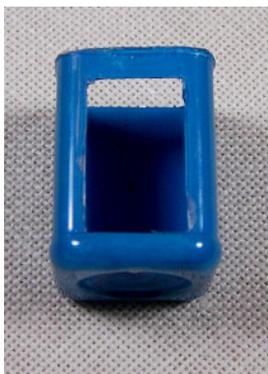
Unser Automat besteht aus 2 Teilen. Für das Unterteil trennen Sie mit einem Cutter (oder sägen mit einer kleinen Kreissäge) die Flasche in der Mitte des Wulstes zwischen Unter- und Oberteil auseinander und versäubern die Schnittkanten bei Bedarf mit feinem Schmirgelpapier. Nun schneiden Sie mit dem Cutter die Öffnung für die Geldeinwurf- und Warenausgabendeckelung aus dem Quader heraus.
