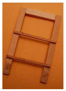
Ist der Kleber getrocknet, drehen Sie die Werkstücke vorsichtig herum. Markieren Sie auf den beiden Ständern jeweils in einer Höhe von 30mm und 55 mm die Klebestellen für die Querträger der Regale (Regalhalter) und leimen diese fest.
