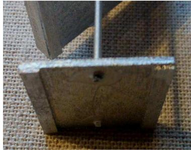
Winkeln Sie nun den Steckdraht mit einer Flachzange bei einer Länge von 130 mm im rechten Winkel ab, geben die Breite des Zeitschriftenhalters zu und winkeln erneut den Draht um 90° wieder zurück. Bringen Sie beide Enden auf die gleiche Länge, stecken diese durch die Bohrlöcher in der Bodenplatte und verleimen sie mit Uhu hart.
